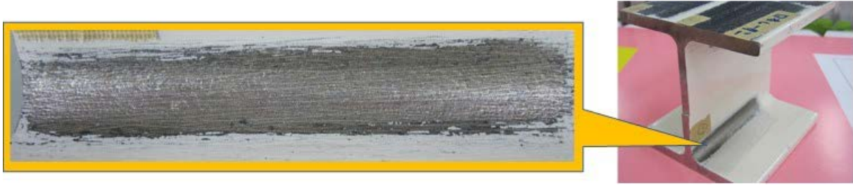
図6 ハンディ式レーザーによるH鋼凹み角部の塗膜分離状態
