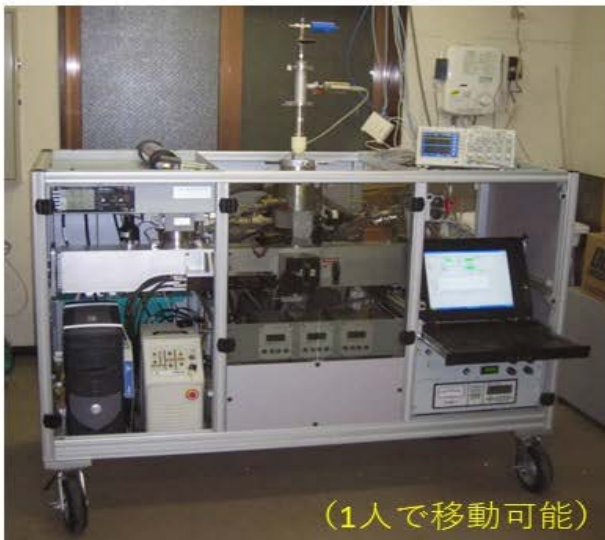
図 3.3-1 ATOFMS の (上) 概略図と (左) 実機写真
