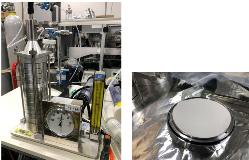
図 3.2-8 ZrO 2 試料の粒径別重量濃度測定のための多段多孔式カスケードインパクター (左) ZrO 2 試料をレーザーアブレーションさせ発生させた微粒子を、粒径別に捕集するために用いた多段多孔式カスケードインパクターLP-20。 (右) 微粒子を捕集する PTFE フィルター。このフィルター上の ZrO 2 (Y 2 O 3 ) 含有微粒子硫酸/フッ酸溶液を添加してマイクロ波溶解させ ICP-AES で定量した。
