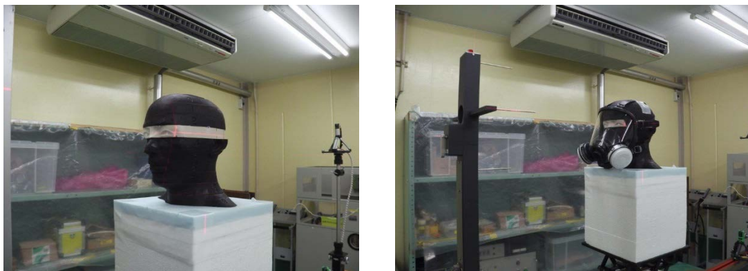
図 9.3.5 β線照射試験の配置 (左：全面マスク無し，右：全面マスク有り)
