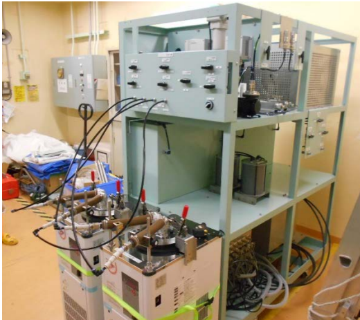
図 3.2.2-3 作業風景写真：第二付属排気筒トリチウム・カーボンサンプラの更新
