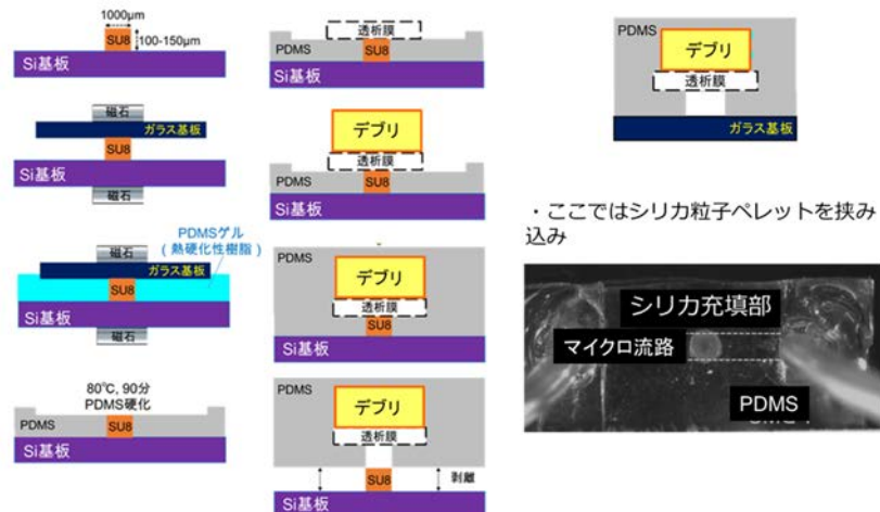
図 3.2-7 模擬デブリを内包したマイクロ流路の作製工程
