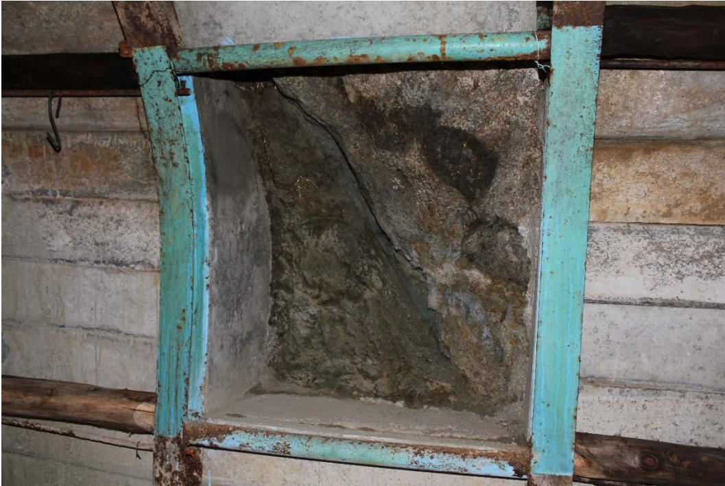
Photo.13 北延上盤坑道で見られた月吉断層
