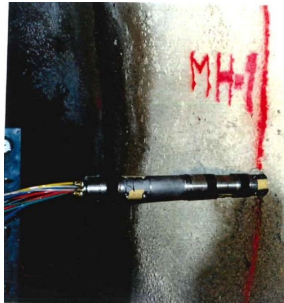
(b) ボーリング孔への設置状況 113)
