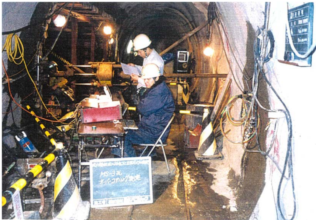
Photo.39 北延 NATM 坑道での応力測定 50) (奥に見える試錐機で、水平に向かって右方向に、ボーリングを行って測定する。)
