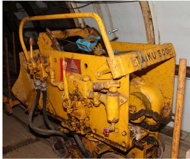
(b) ロードヘッダー (坑道掘進時に用いる積み込み機。 前方にバケットがある。)
