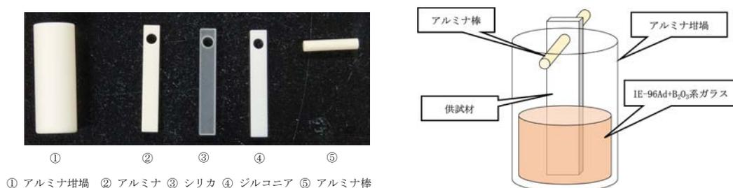
図 3.1-55 供試材の外観および浸食試験の概略図
