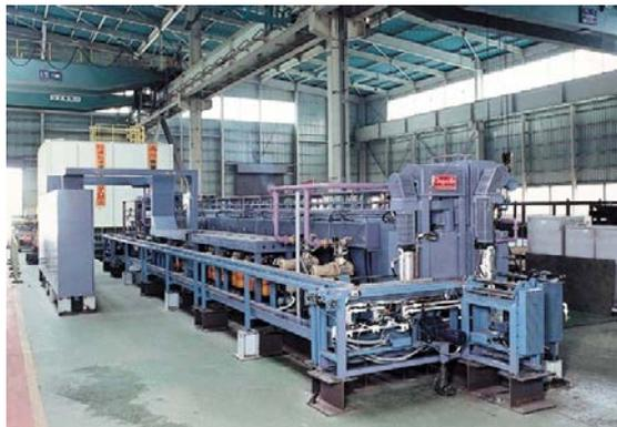
図 3.3-3 ローラーハースキルン装置の外観写真（写真提供：中外炉工業株式会社）
