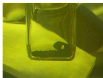
図 3.2-4 粉碎した燃料および被覆管
