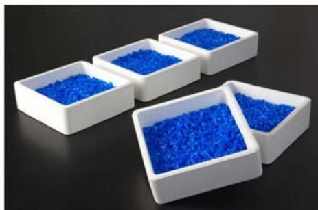
図 3.3-4 焼成用磁性坩堝の外観写真（写真提供：余語匣鉢株式会社）
