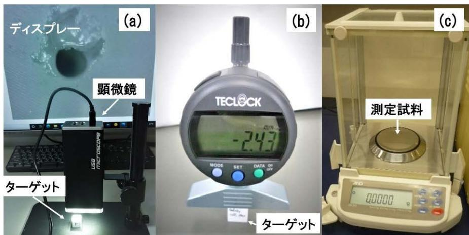
図 3.4.1-17 (a)USB 顕微鏡、(b)デプスゲージ、(c)電子天秤
