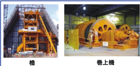
・埋め戻し材をキブル(運搬容器)へ投入 ・キブルを地上から立坑坑底へ、橋、巻上機設備を用いて運搬
