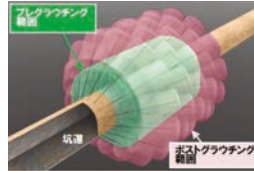
プレグラウチングとポストグラウチングの概念図
