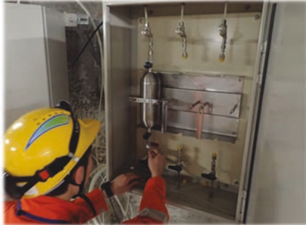
深度500mアクセス北坑道での採水作業(冠水坑道)
