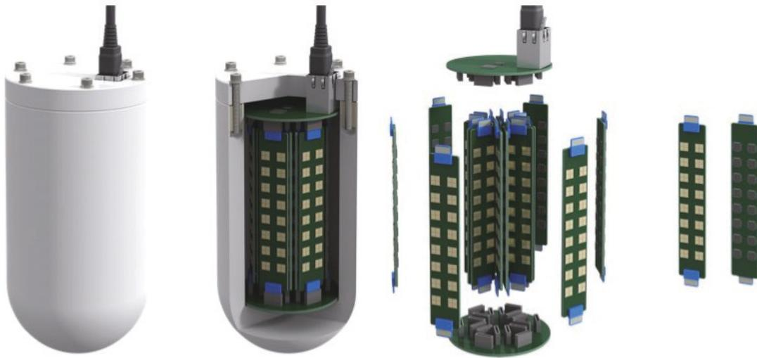
図 3.1.2-2 ペネトレーション穴径 10 cm 用の中性子検出器デザイン
