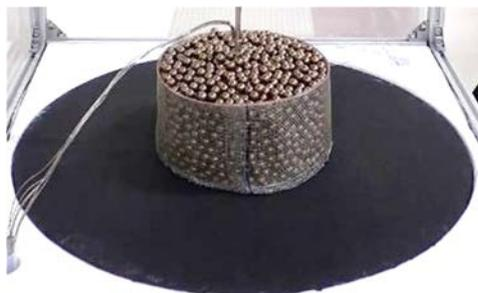
図 1 解析体系図。中央に SUS の球体をポーラス体として設置。その下の円形黒い部分が加熱面
