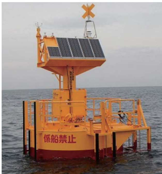
図 5-4 再処理施設の海洋放出口近傍に設置された係留式観測ブイ 69)
