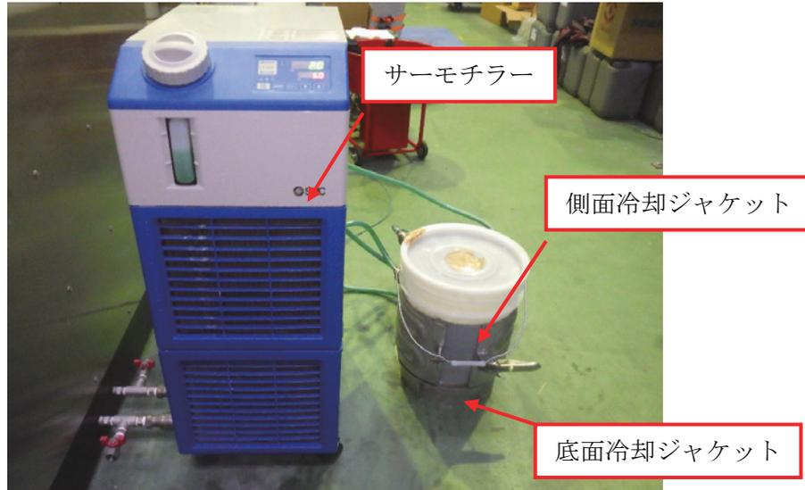
図 3.3-14 サーモチラーと冷却ジャケットを使用した試験体冷却機構
