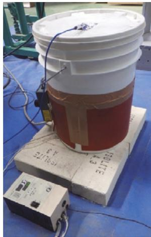
図 3.3-11 パイロットサイズ試験体の加熱方法
