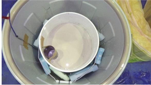
図 3.3-10 パイロットサイズ試験体の冷却方法
