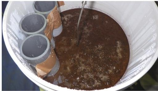
図 3.3-13 鉄共沈模擬廃棄物添加パイロットサイズ試験体の外観
