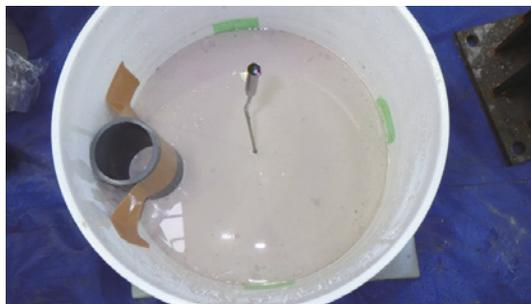
図 3.3-12 クラックのないパイロットサイズ試験体
