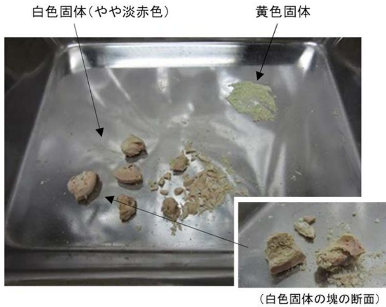
図 3.1.1-14 バットに取出したフッ化試験後試料の外観写真 (Run3)
