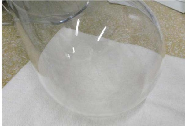
図 3.3.2-11 試料加熱後の石英ベルジャー頂部の外観写真
