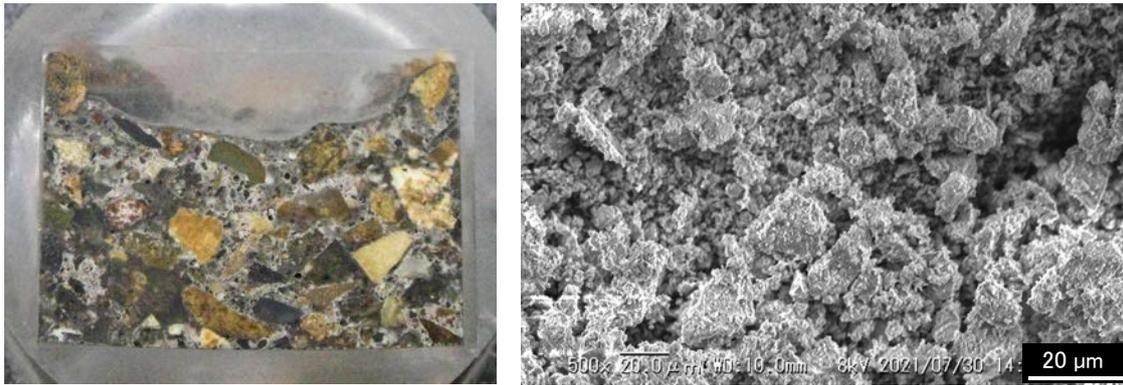
(a) 未加熱コンクリート片の断面写真（参考）と分析用粉末のSEM像
