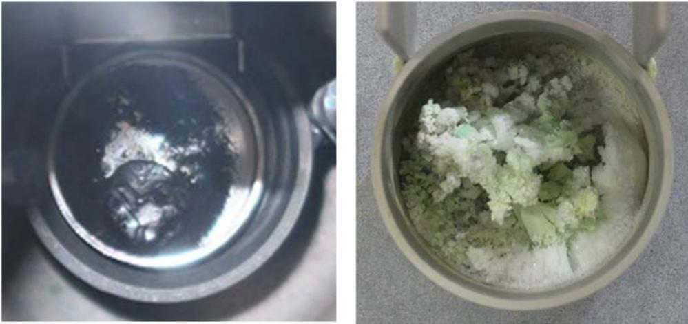
図 3.1.1-3 フッ化試験前後の試料の外観写真 (Run1)
