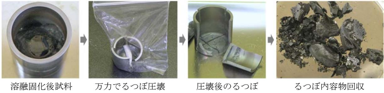
図 3.3.1-3 集光加熱後の試料回収時の外観（試料 C）
