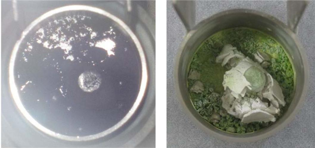
図 3.1.1-8 フッ化試験前後の試料の外観写真 (Run2)
