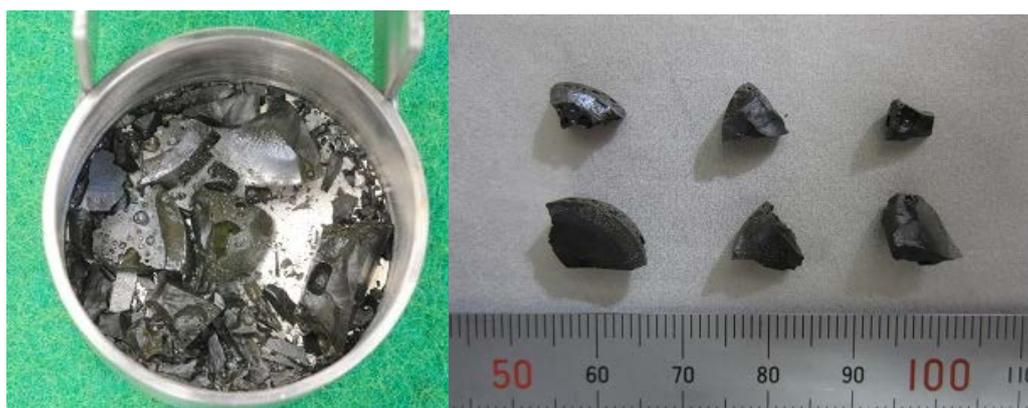
図 3. 1. 1-12 フッ化試験前の試料の外観写真 (Run3)
