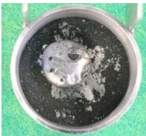
図 3.1.1-2 フッ化試験前の試料の外観写真 (Run1)
