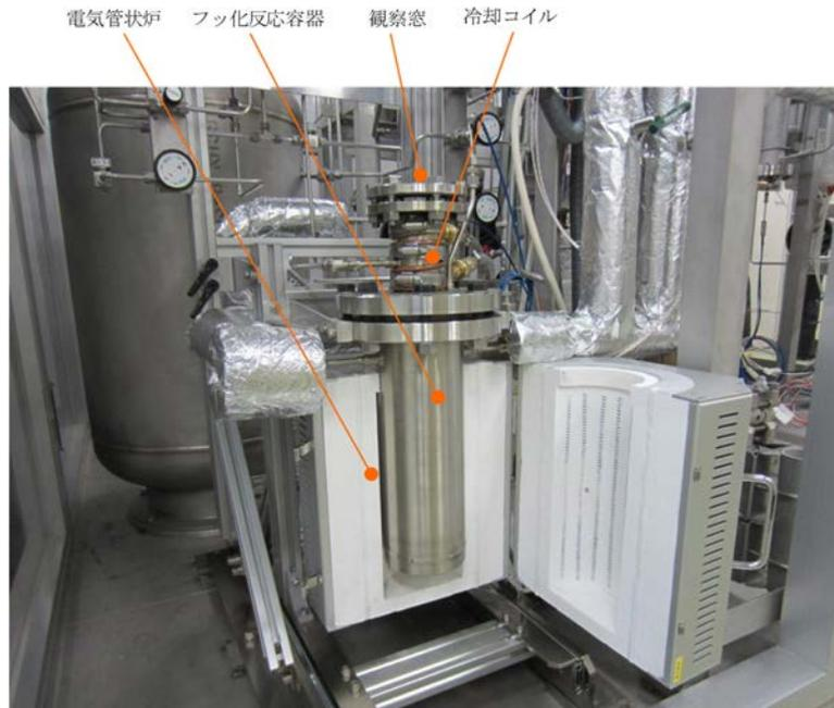
図 3.1.2-7 フッ化反応炉の外観写真
