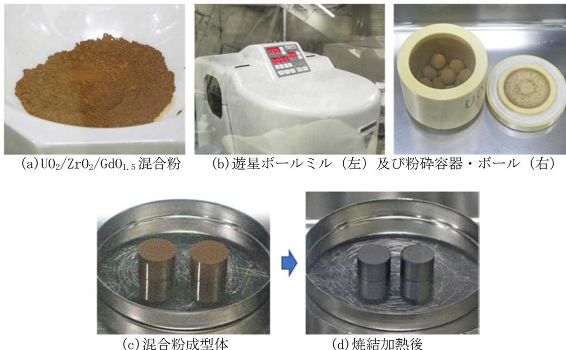
(c) 混合粉成型体 (d) 焼結加熱後
