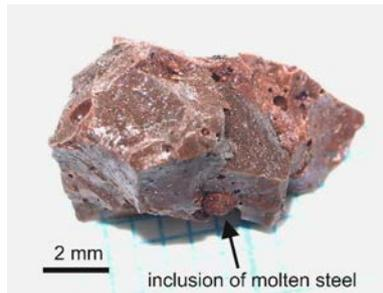
図 3.1.2-38 フッ化試験に用いたチェルノブイリ実デブリ
