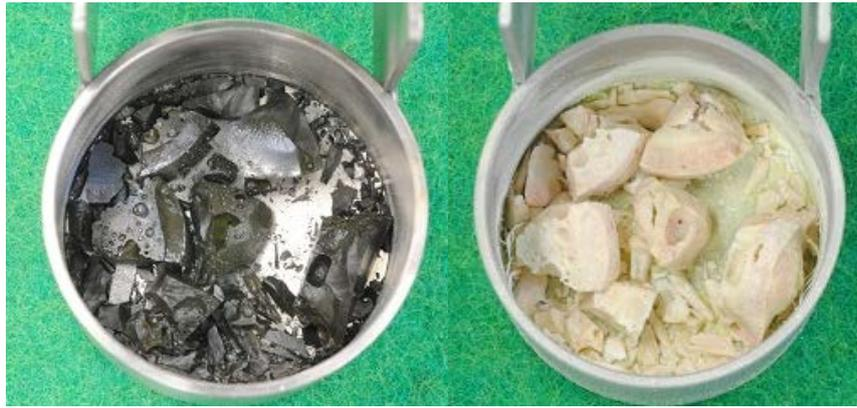
図 3.1.1-13 フッ化試験前後の試料の外観写真 (Run3)
