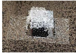
図 3.3-11 SfM 技術と超音波計測技術による形状再構成情報を ICP 技術により整合させた画像例[3]
