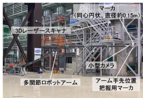
図3.1-4 檜葉遠隔技術開発センターの簡易的な模擬環境施設における多関節アームを用いた基礎実験（探索動作検証及び手先位置の測定）[3]
