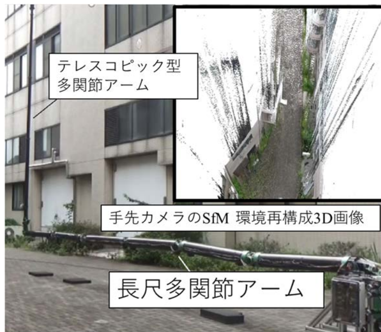
図 3.1-9 テレスコピック型多関節アームを長尺多関節アームへ統合化させた 拡張型スーパードラゴン多関節ロボットアーム
