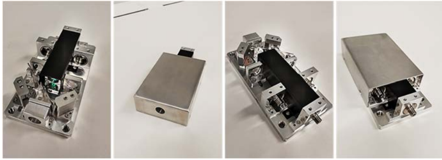
図3.2-4 試作したマイクロチップレーザーLIBSプローブ（外景、カバー内部） [3]
