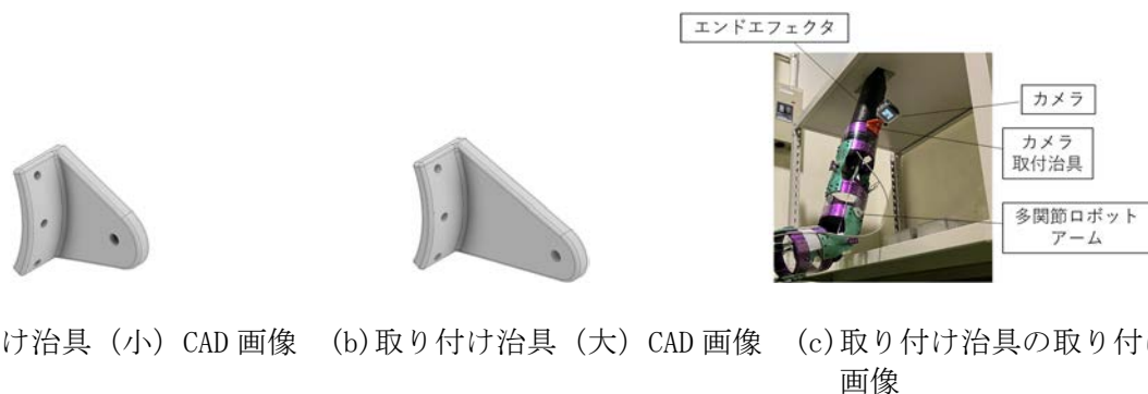
図 3.3-23 ロボットアーム先端部にカメラを実装するために 試作したエンドエフェクタ部（カメラ取り付け治具）
