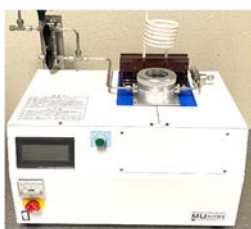
図 3.2-10 令和元年度に新規購入した卓上型高周波誘導加熱装置 MU-mini[2]
