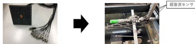
(a) 令和2年度試作したアレイ型 空中超音波センサ
