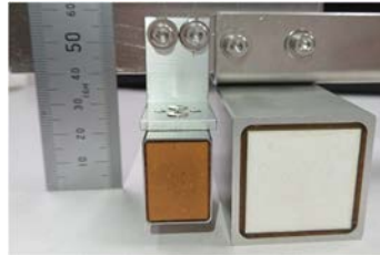
図 3.3-1 パラメトリック超音波センサ[2]
