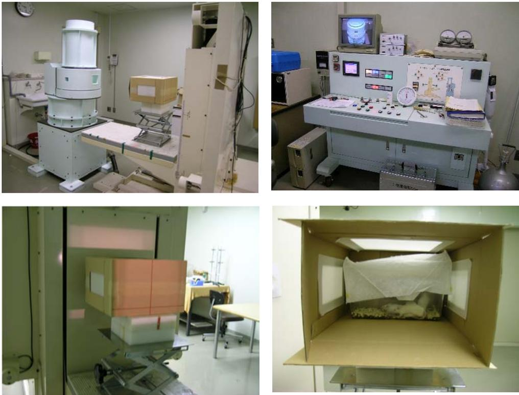
図 3-24 A/J マウスへの Cs-137  $\gamma$  線外部照射装置と照射状況
