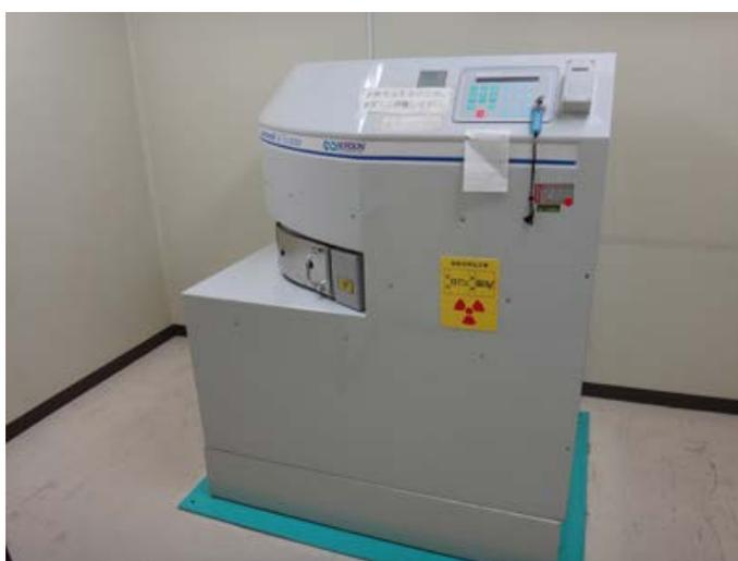
図3-25 高線量率照射用 Gammacell 40 Exactor
