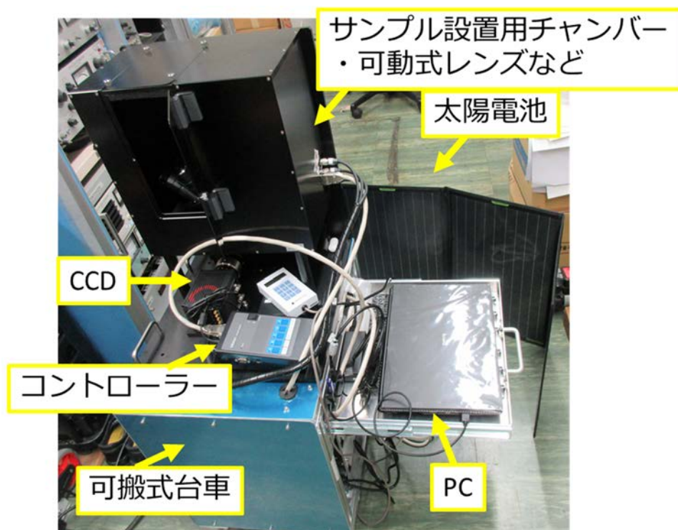
図 3.2.4-11 可動式にしたイメージング検出器の写真（JAEA にて） （[7] より引用）
