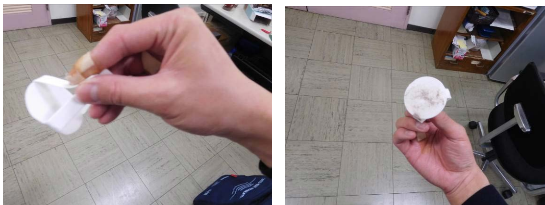
図 3.2.3-2 スミヤろ紙を用いた粒子のサンプリング試験 （[2]より引用）
