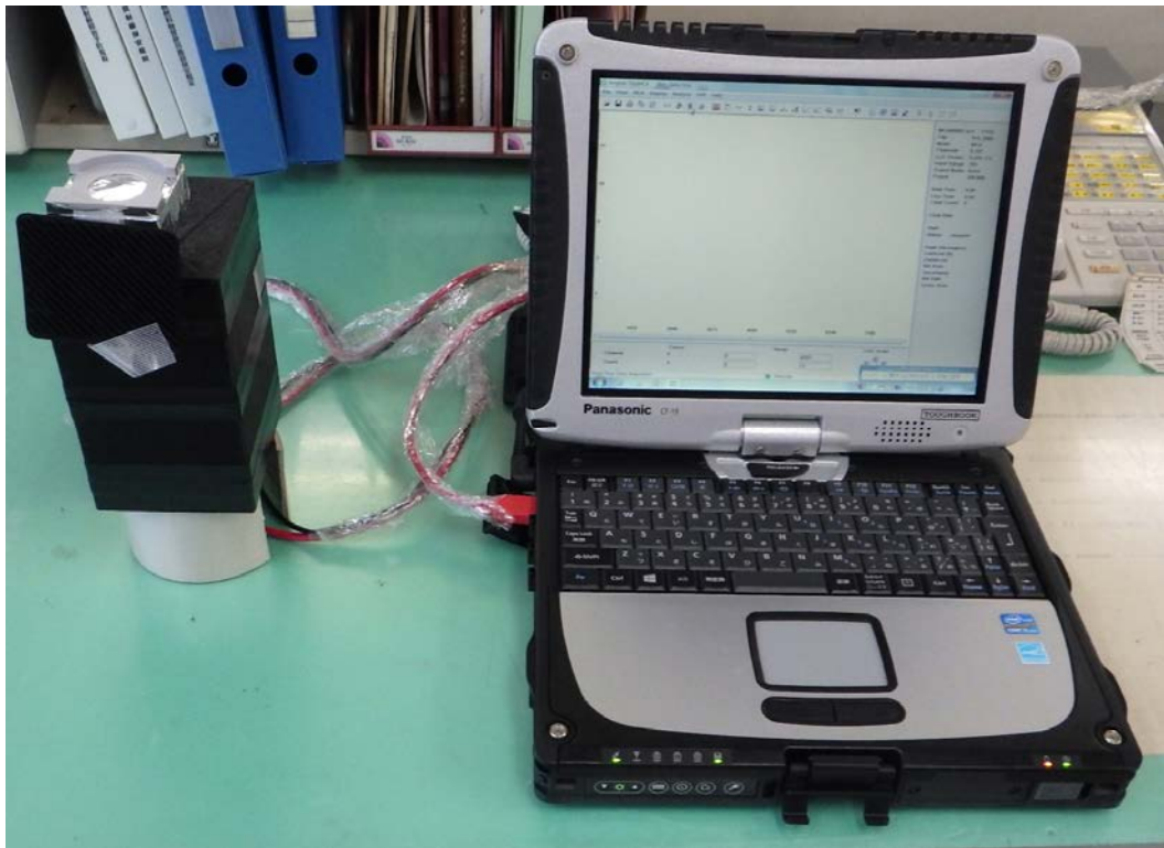
図 3.2.2-16 改良したエネルギースペクトル測定装置でのセットアップ（[7]より引用）
