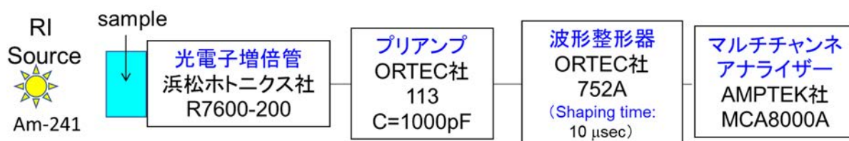
図 3.1.1-4 発光量測定の設定アップ ([2]より引用)
