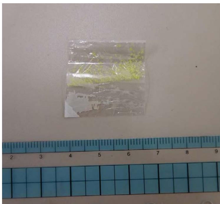
図 3.2.3-5 粉末状シンチレータ ([2]より引用)
