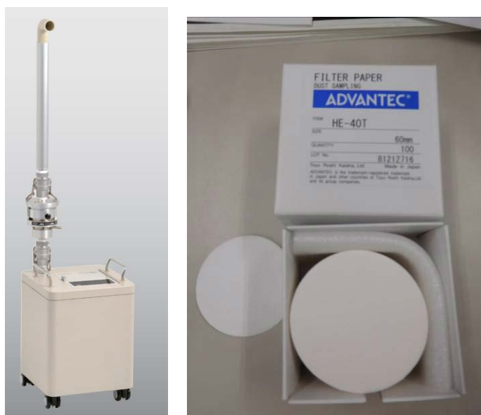
図 3.2.3-1 ポータブルダストサンプラ（左）と HE-40T ろ紙（右）（[2]より引用）
