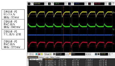
④センサ入力と受信側ボードの出力
