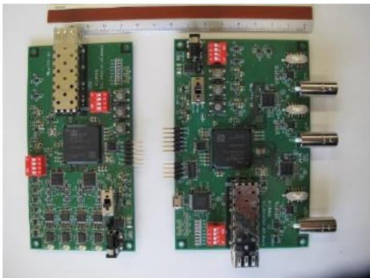
図 3.2.1 データ転送装置（左：出力側、右：受信側）
