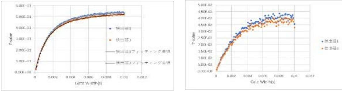
図 3.3.15 2 分割炉心での実験の Feynman- $\alpha$  法の Y 値
