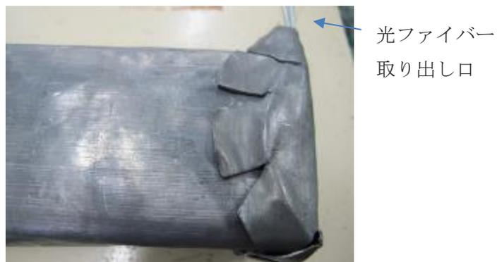
図 3.4.11 作製した鉛遮蔽体
