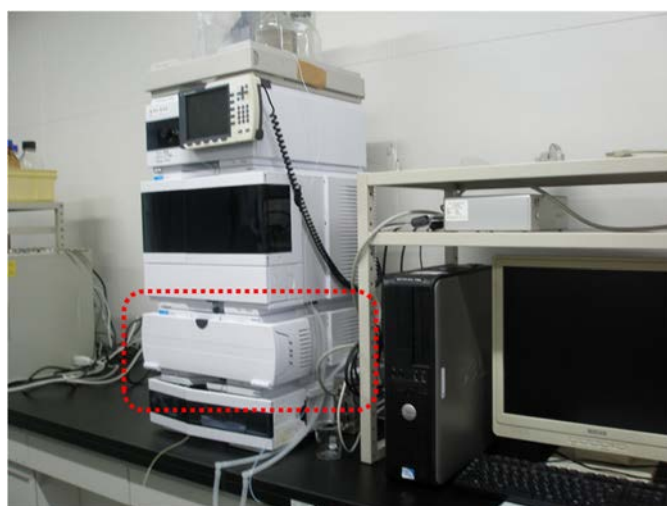
図 3.1.4-8 カラム温度を安定化させるためのカラムコンパートメントを導入した液体成分分析用の液体クロマトグラフ （破線で囲った部分がカラムコンパートメント）
