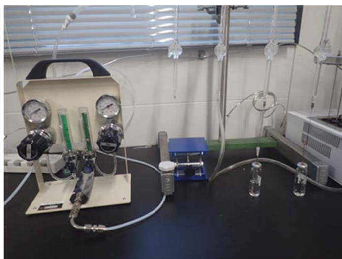
図 3.1.4-14 酸素濃度調製用ガス混合装置（左）および調製中の試料（右）
