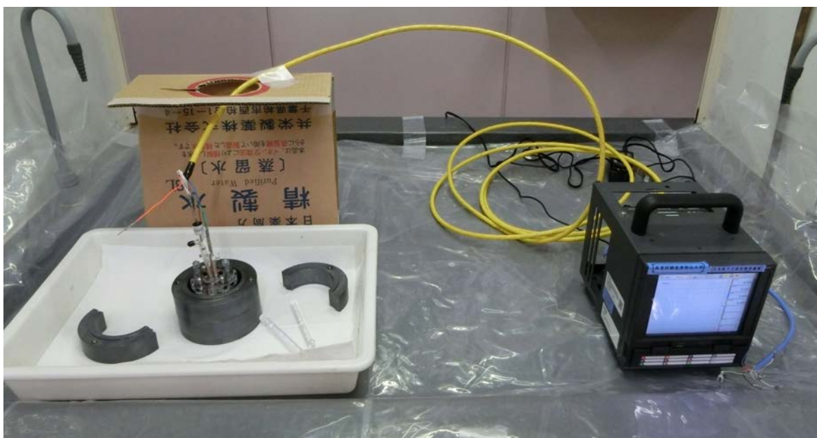
図 3.1.3-4 β線照射下電気化学試験の試験系
