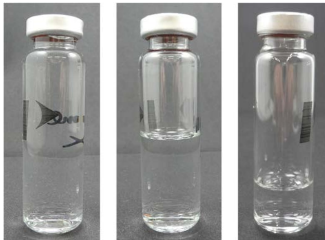
図 3.1.4-11 気液の割合を制御した水試料 左から気液組成比は、気：液=0：100、50：50、75：25
