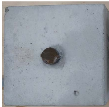
健全 ひび割れ幅なし
