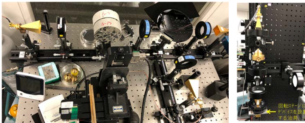
図 3.2-2 近距離による詳細診断を志向した周波数選択計測システムの光学系 (左) レンズ変更によるビーム径可変測定系、 (右) 精密ステージを用いる偏光回転測定系
