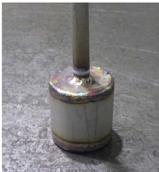
SUS カプセルの外観 (Run-3) (真空加熱脱気前、脱気管付き蓋溶接後)
