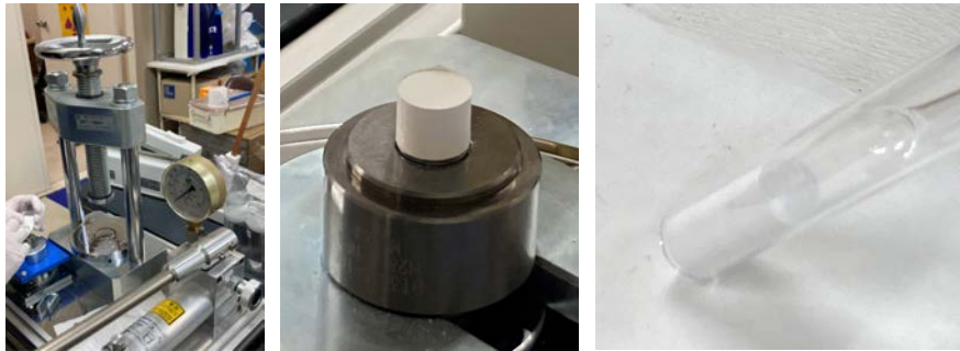
図 3.1-9 RI 製造用に \text{BaCl}_2 を成型体化して枝付き石英管に封入する様子
