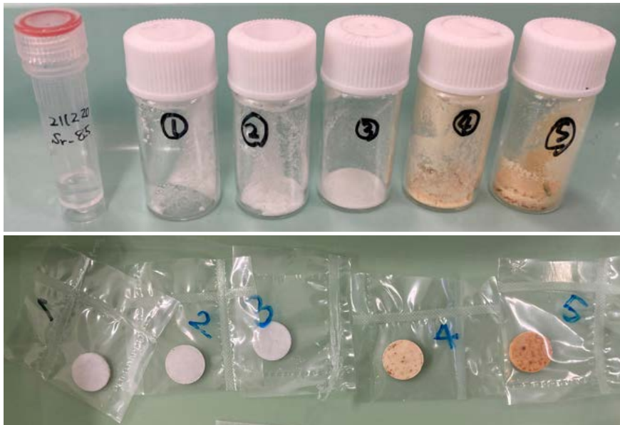
図 3.1-10 ^{85}\text{Sr} をドープした ALPS 沈殿系廃棄物リン酸塩廃棄物 (①、②、③が炭酸塩沈殿、 ④、⑤は炭酸塩沈殿と鉄共沈の混合を想定したリン酸塩、 上図は粉体、下図は圧縮成型体)
