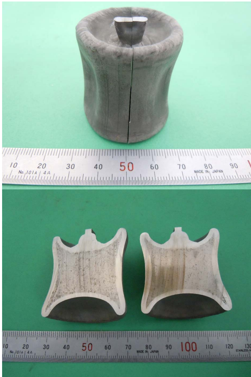
図 3.4-13 ALPS 沈殿系模擬廃棄物固化体の HIP 処理後写真 (Run-3)
