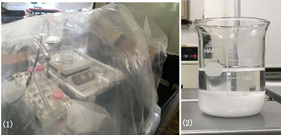
図 3.1-1 I-CaHAP 合成時の様子 (1) 窒素環境下での合成、(2) 熟成、静置
