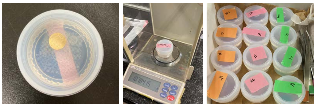
図 3.1-16 浸出試験の様子
