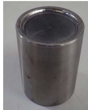
EB 溶接後の Nb カプセル
