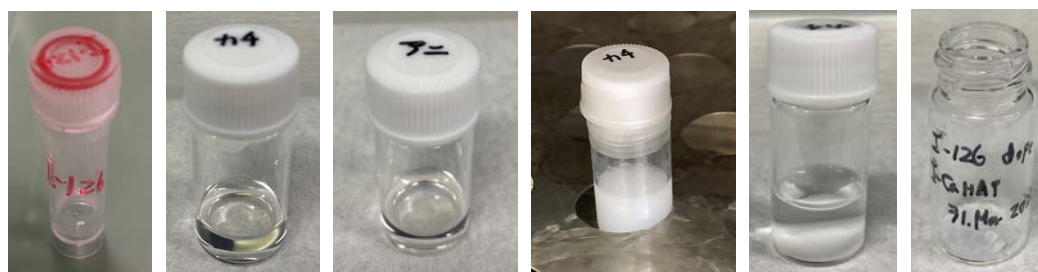
図 3.1-12 ^{126}\text{I} をドーブしたヨウ素アパタイト ( ^{126}\text{I} -CaHAP) (左から、ストック溶液、カチオン原料を溶かした溶液、アニオン原料を溶かした溶液、 カチオン溶液にアニオン溶液を加え pH を上昇させ 80 °C で熟成、遠心分離、 完成した ^{126}\text{I} -CaHAP)
