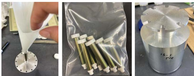
図 3.1-13 重水素化したリン酸塩固化体粉末の中性子回折実験用試料ホルダーへの据え付け
