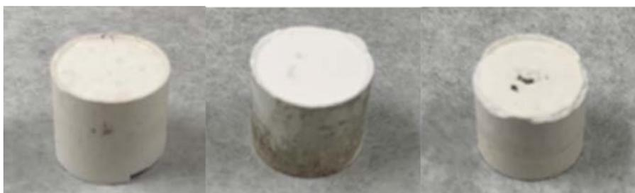
図 3.2-3 浸出試験前の試験体サンプル（左から、SC2（1 h）、SC2（3 h）、SC2（5 h））
