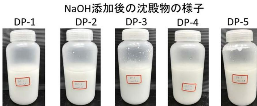
図 3.3-16 模擬炭酸塩スラリーからのリン酸塩化合物の合成プロセスの最適化試験 (合成) で生じたリン酸塩化合物の様子
