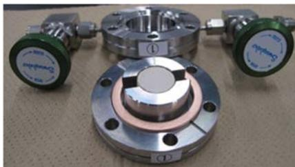
図 3.5-2 試料を装填した照射セル (密封前)
