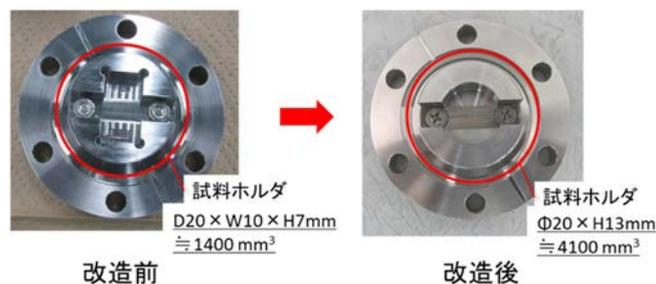
図 3.5-1 照射セル試料ホルダーの改造
