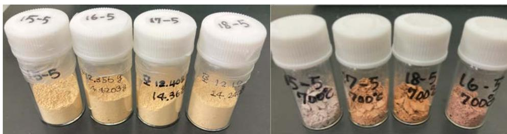
図 3.1-12 重水素化したリン酸塩固化体粉末の合成例
