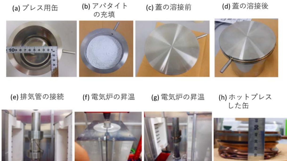
図 3.4-3 圧縮缶でのホットプレス試験の手順
