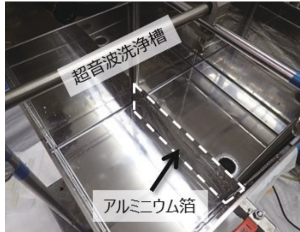
図2 超音波洗浄効果の評価実験の様子
