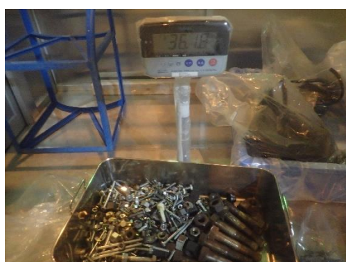
磁性を有する鋼製ボルト、鋼製ナットは内容物の分類が容易だが、数が多く、しかも重い。
