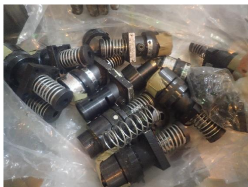
ショックアブソーバ等の複合構造物も封入されており、分解してオイルを除去し、鉄、真鍮、アルミに分類
