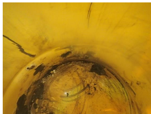
ドラム缶の底は化学変質をして塗装浮きも確認できる。
