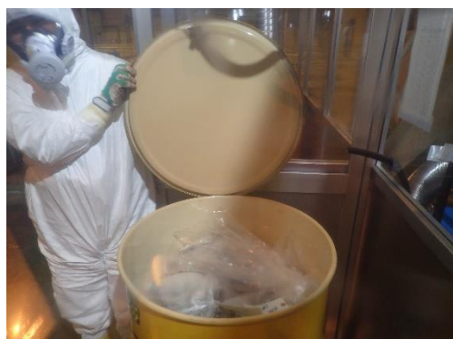
「不燃直廃」開缶調査の開封直後
