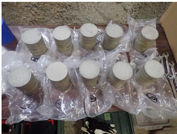
(a) 充填したベントナイトブロック
