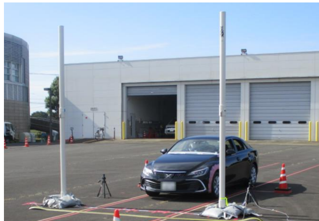
図 5.2-2 車両用ゲート型モニタの例（株式会社千代田テクノル製：ガンマ・ポール）
