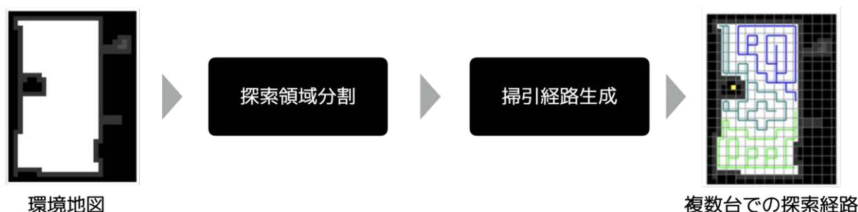
図 3.3-2 複数台ロボットによる対象空間全体の探索
