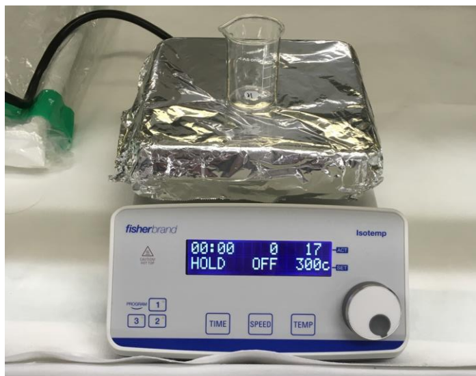
図 3.3-7 フィルター上に捕集した \text{ZrO}_2 を溶解中の外観
