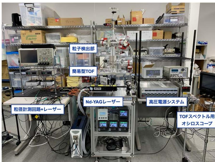
図 3.1-29 粒子検出部評価用 ATOFMS システムの全体写真
