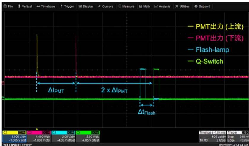
図 3.1-20 信号検知・タイミング制御回路のタイミングチャート
