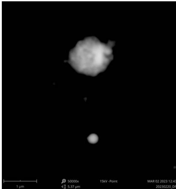
図 3.4-8 ZrO<sub>2</sub>を原料とし流量 50 μL/min にて 30 分間捕集した肥大化後の試料の SEM イメージ
