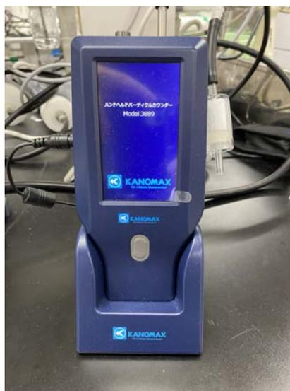
図 3.2-16 光散乱式粒子カウンター (OPC) の外観写真
