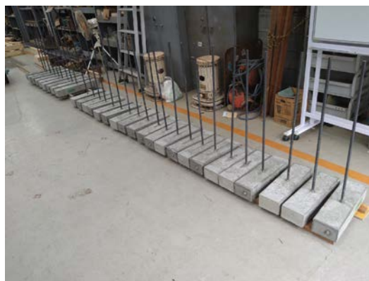
図 3.3.2-3 鉄筋腐食によるひび割れを模擬した付着強度試験体
