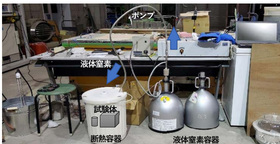
図 3.3.1-3 急速凍結融解試験装置
