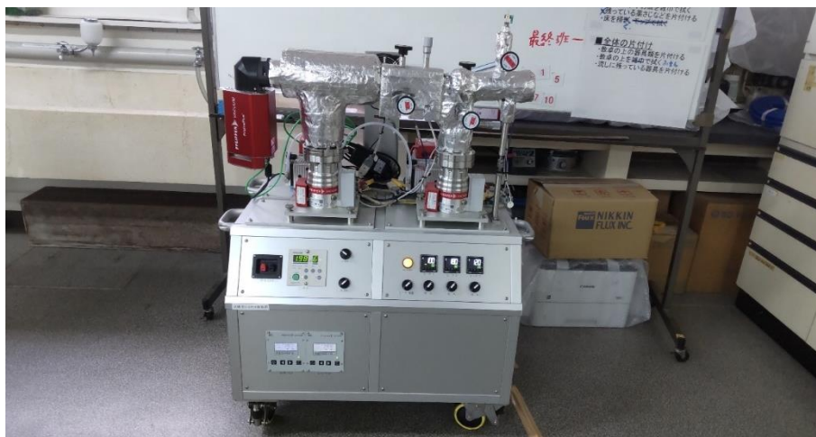
図 5 食材の香り数値化で使用している高感度ガス質量分析装置
