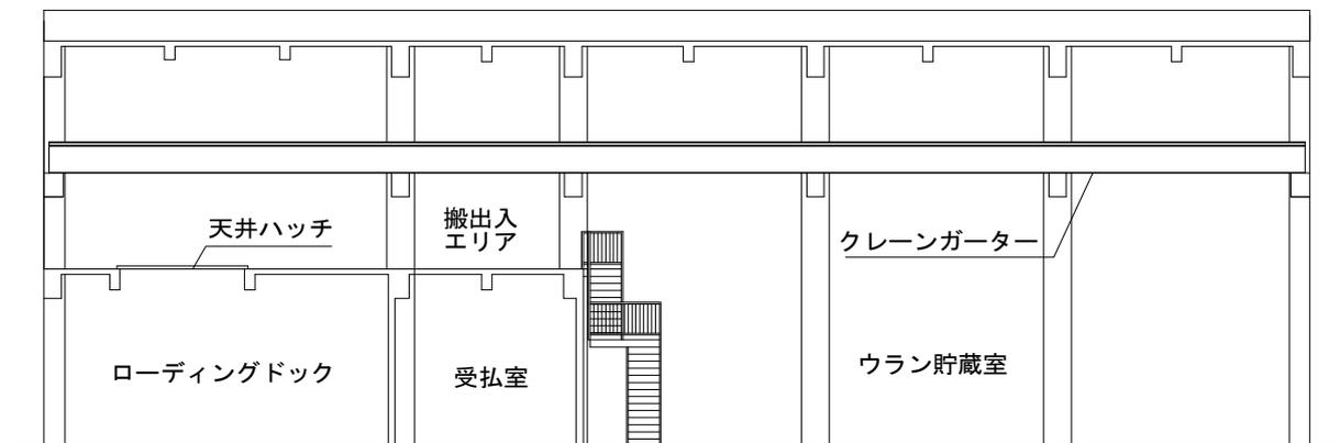
図 6.1-4 搬出入設備の配置図（正面図）
