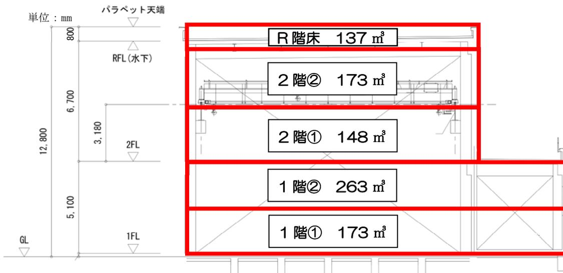
図 6.1-8 コンクリート打設区分図
