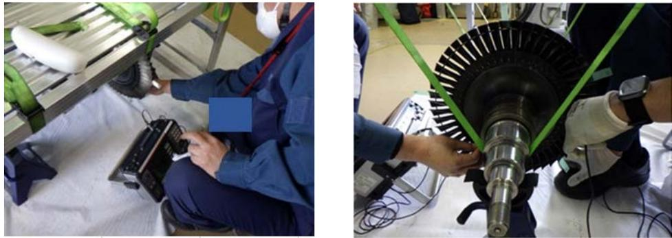
写真 4.5-3 超音波探傷検査
