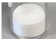
図 3.1.1-18 模擬汚染水 C 由来の溶離液から得られた Sr 固化体
