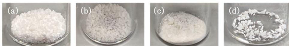
図 3.1.1-8 添加剤 1 を添加して様々なアルカリ濃度で作製した材料 (作製法 C)
