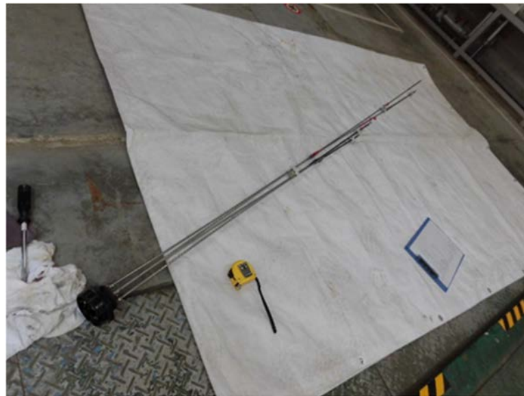
写真 2. 2. 14-1 水槽から引き抜いた電極棒
