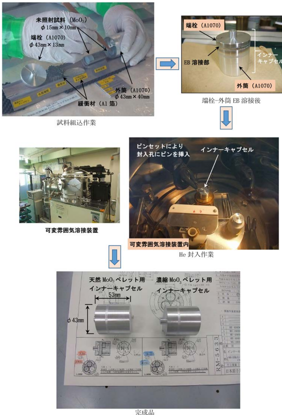
写真 2.4.1-1 WWR-K 炉(カザフスタン)照射用インナーキャプセルの組立
