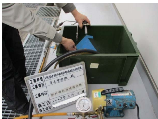
写真 2.2.13-1 燃料噴射弁噴霧試験
