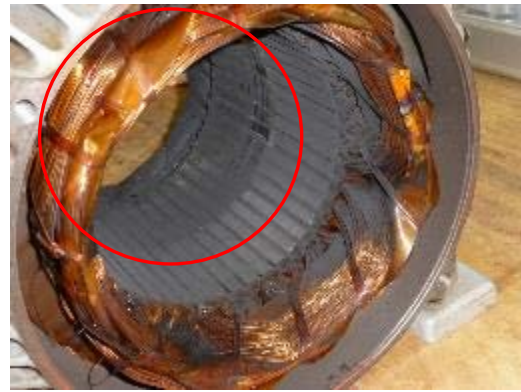
写真 2.2.3-2 電動機内レアショート発生部
