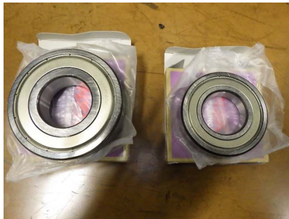
写真 2.2.17-2 新たに取り付けた軸受
