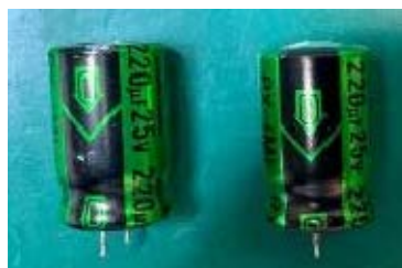
写真 2.4.2-2 経年劣化の進んだアルミ電解コンデンサ
