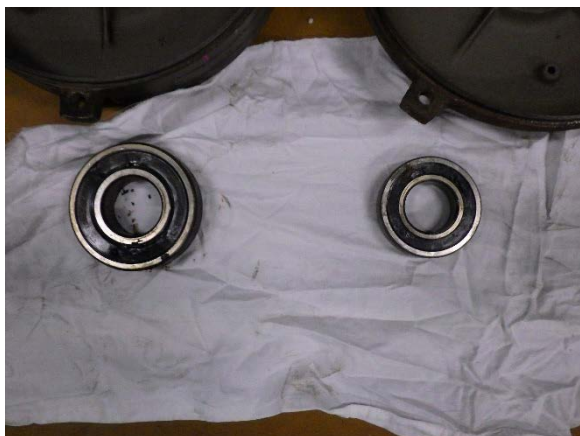
写真 2.2.17-1 摩耗した軸受
