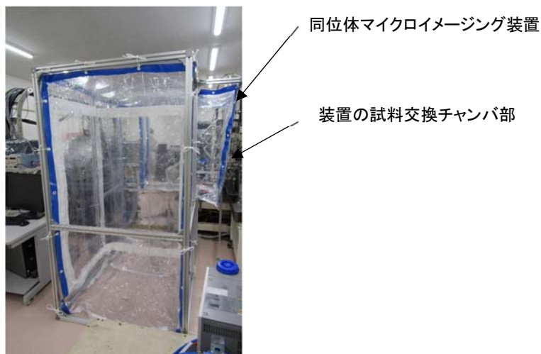
図 3. 4-2 汚染拡大防止用グリーンハウスの設置写真
