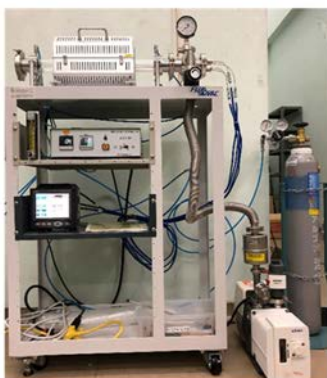
(a) 水素注入装置
