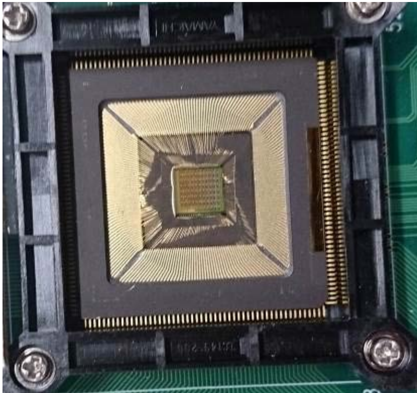
図 3.1.2-1 耐放射線光電子 FPGA 試作チップ
