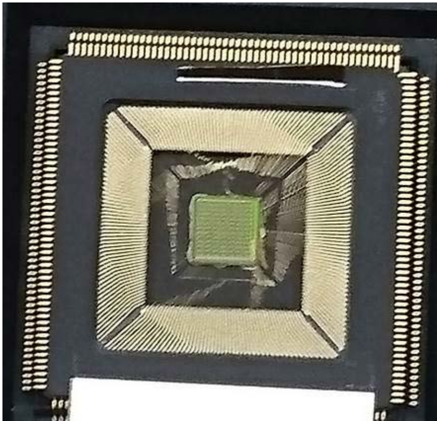
図 3.2.1-1 0.18 \mu\text{m} CMOS プロセスを用いた「光並列構成法」と「部分的に並列化した構成法」の双方の機能を持つ VLSI チップ
