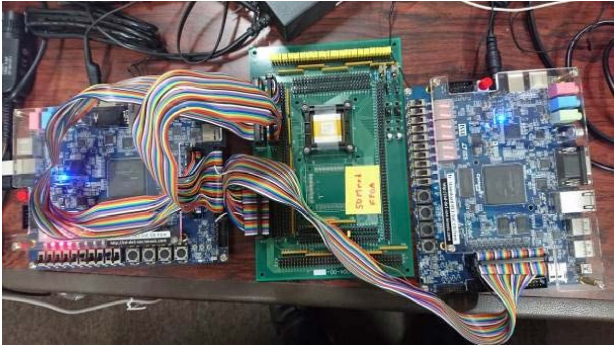
図 3.2.2-1 放射線照射後の VLSI チップ評価の様子
