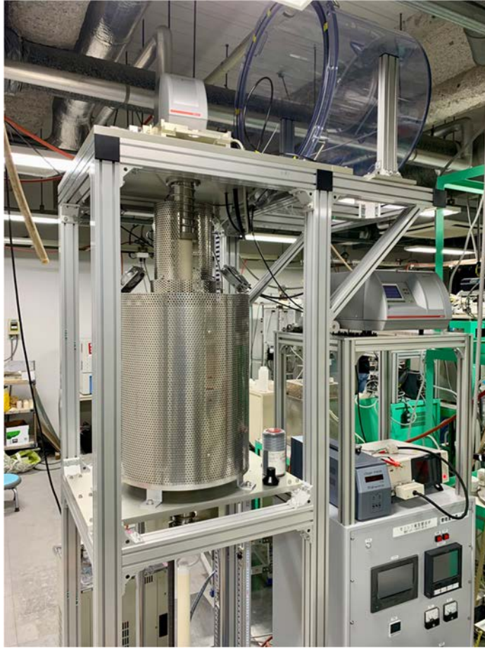
図 3.2.3-1 極低粘度まで検出可能なトルクセンサーを備えた 2023 K まで昇温及び 雰囲気調整可能な電気炉外観
