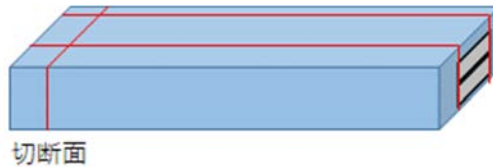
図 3-58 ひび割れ模擬試験片を分析するための切断箇所
