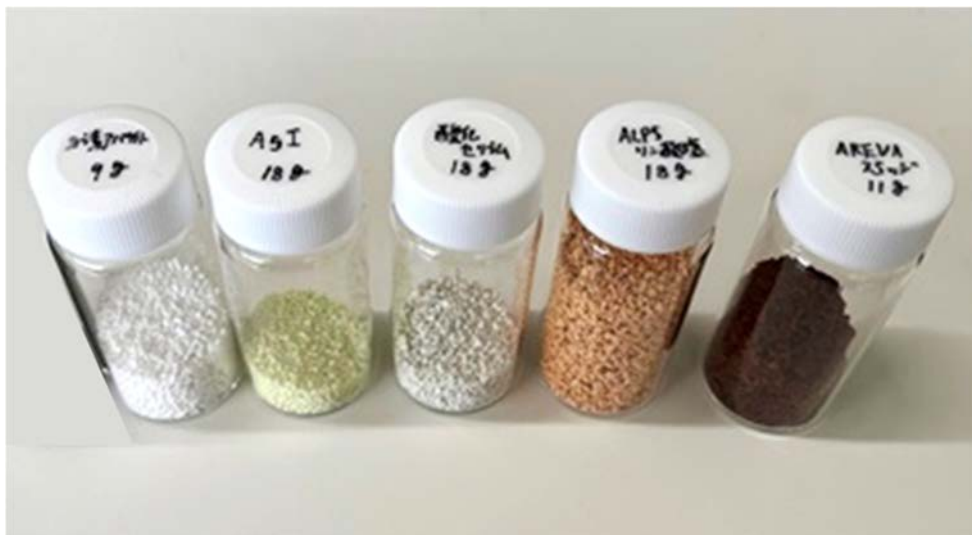
図3.4.1-2 固化処理に用いた1次固化体の造粒体
