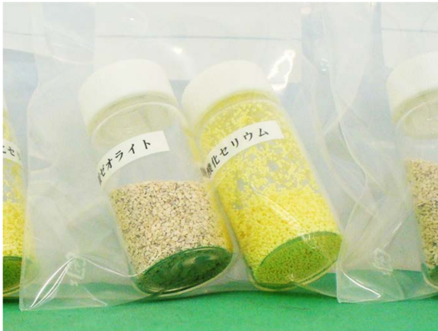
図3.4.1-1 固化処理に用いたALPS吸着材 (左：ALPS銀ゼオライト、右：ALPS酸化セリウム)
