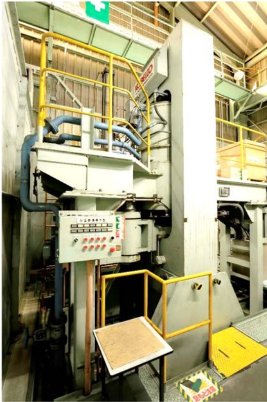
図 3. 4. 1-6 固化処理に用いた HIP 装置と仕様
