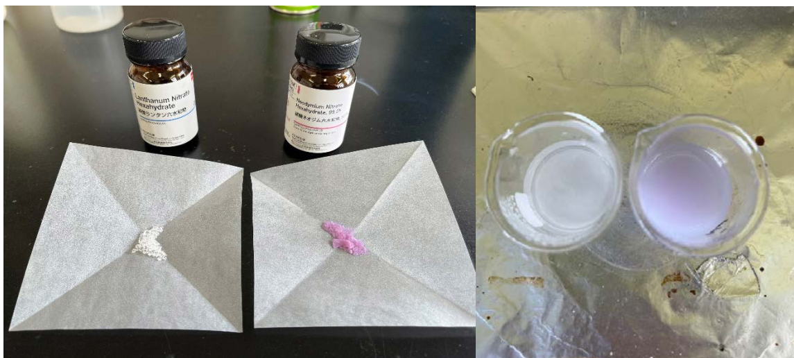
図 3.1.1-1 La、Nd モナザイトの合成：(1) 試薬の硝酸塩、(2) モナザイト沈殿
