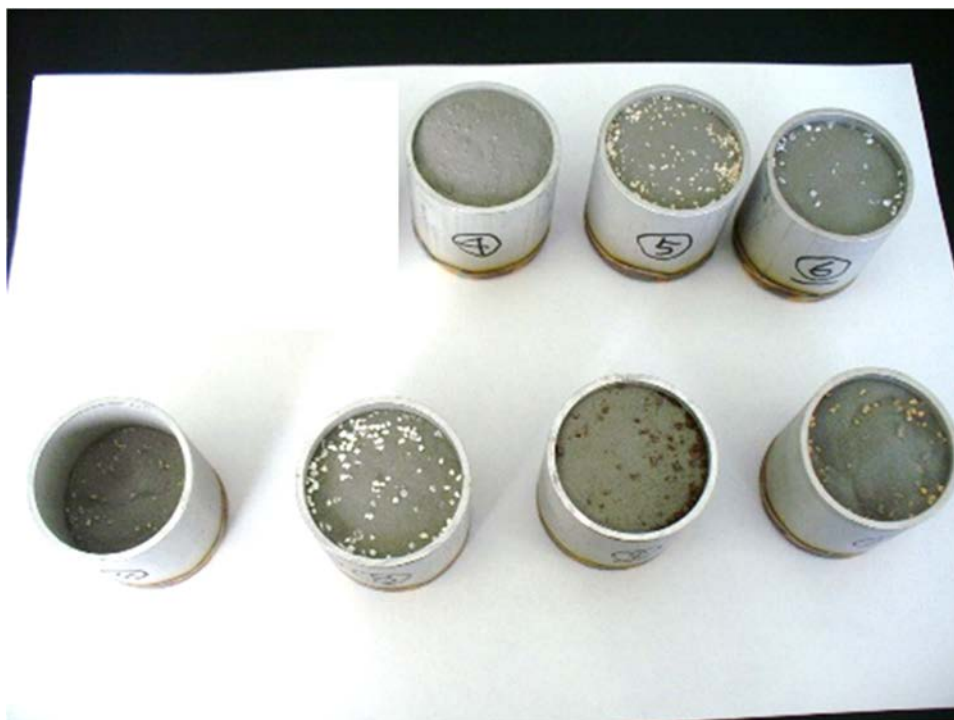
図 3. 4. 1-5 SUS カプセルへの試料充填状況
