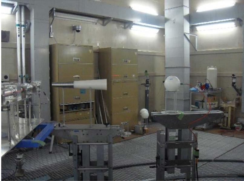
図 3.2-7 ボナー球測定体系（体系 4）の測定実施の様子
