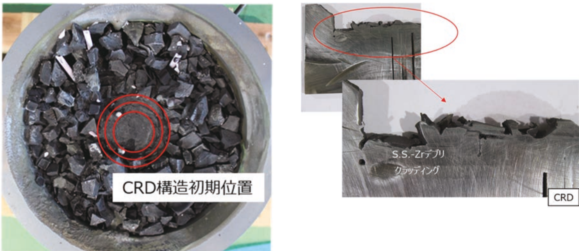
図 3. 2. 3-17 試験後の試験体外観及び試験体断面
