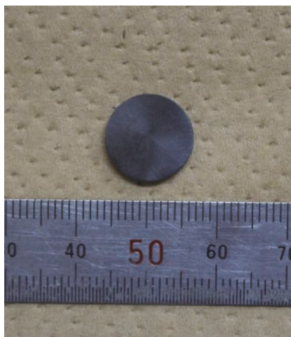
図 3. 1. 1-2 (FeO) 91.8 (UO 2 ) 3.8 (ZrO 2 ) 4.4 焼結体の外観
