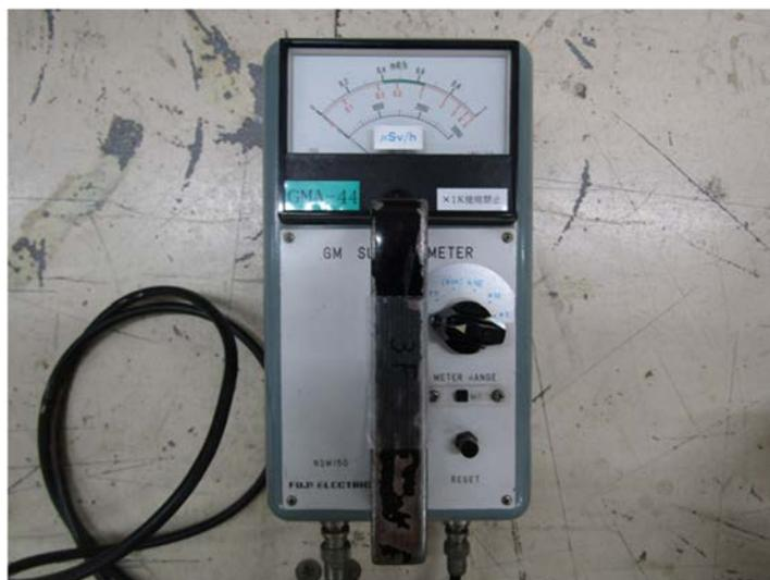
図 3.4-16 試料からの線量当量測定に使用した GM 管式サーベイメーター
