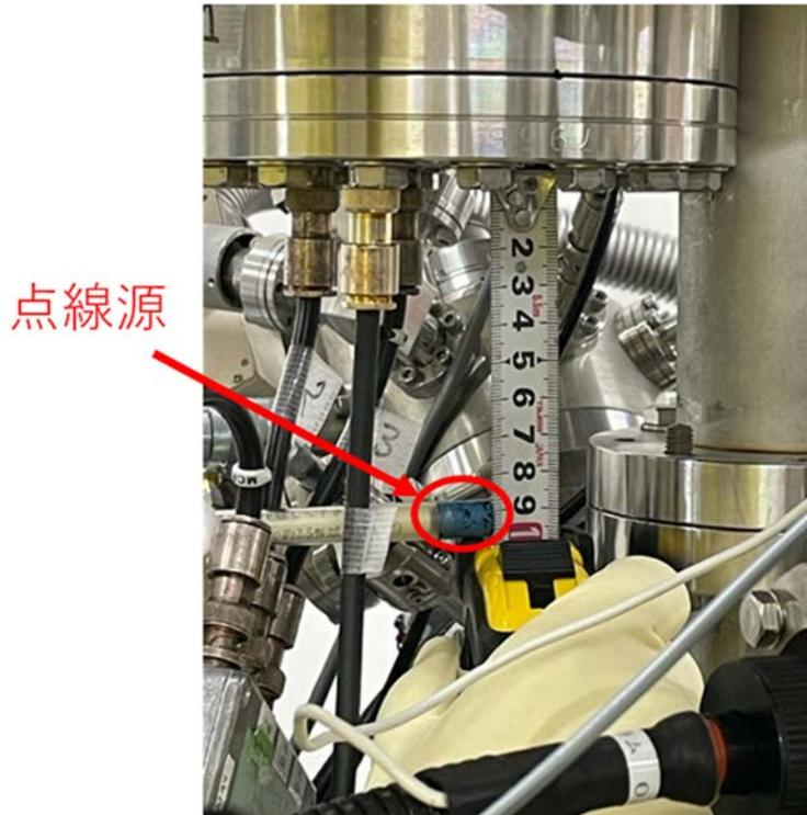
図 3.4-6 標準点線源をポイントに設置している様子
