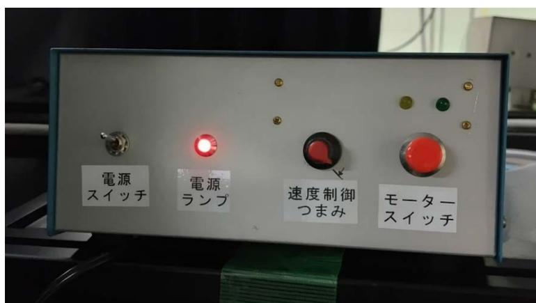
図3.2-10 基本波/SHG切り替え機構（ミラー駆動機構）の制御系の外観
