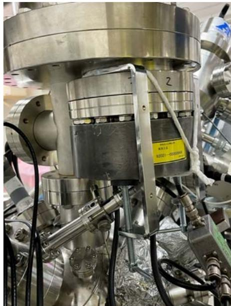
図 3.4-3 設置した放射線シールド材の様子
