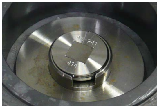
図 3.1.3-7 密封線源 ( ^{241}\text{Am} ) をセットした線源ホルダ写真図
