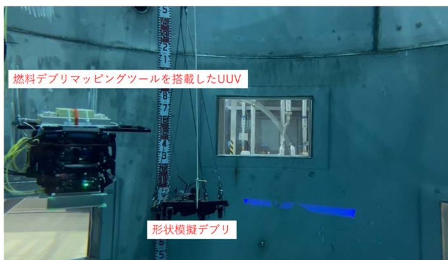
図 3.4-9 燃料デブリマッピングツールを搭載した UUV、形状模擬デブリを水中 LiDAR でスキャンする様子
