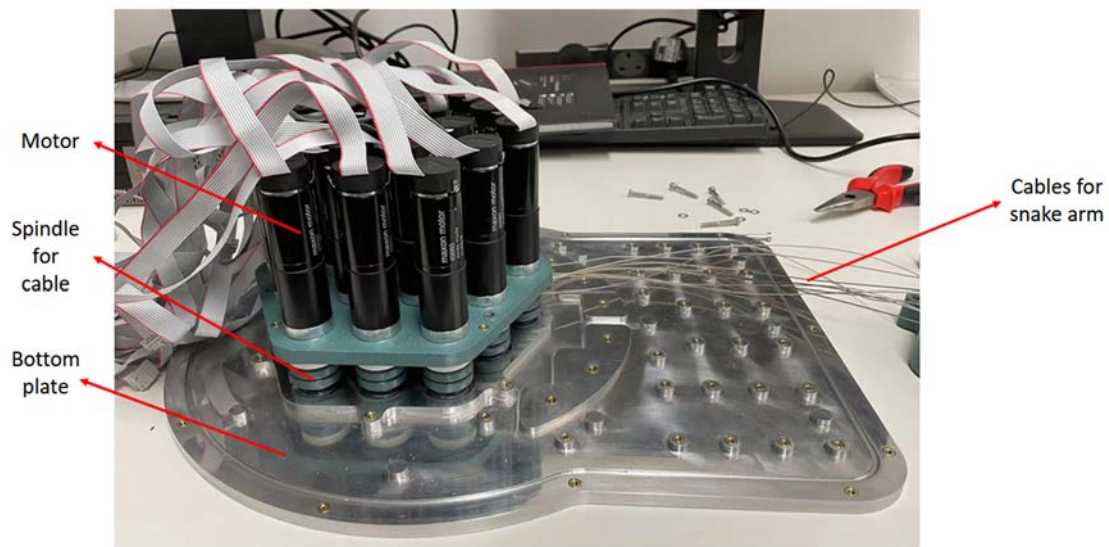
図 3.4-1 モーターユニットと追加生産された旧型スピンドルを組み付けた状態の写真
