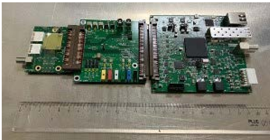
図 3.1-5 UUV に搭載する基板の写真 (左：ASIC 基板、中：アダプター基板、右：FPGA 基板)
