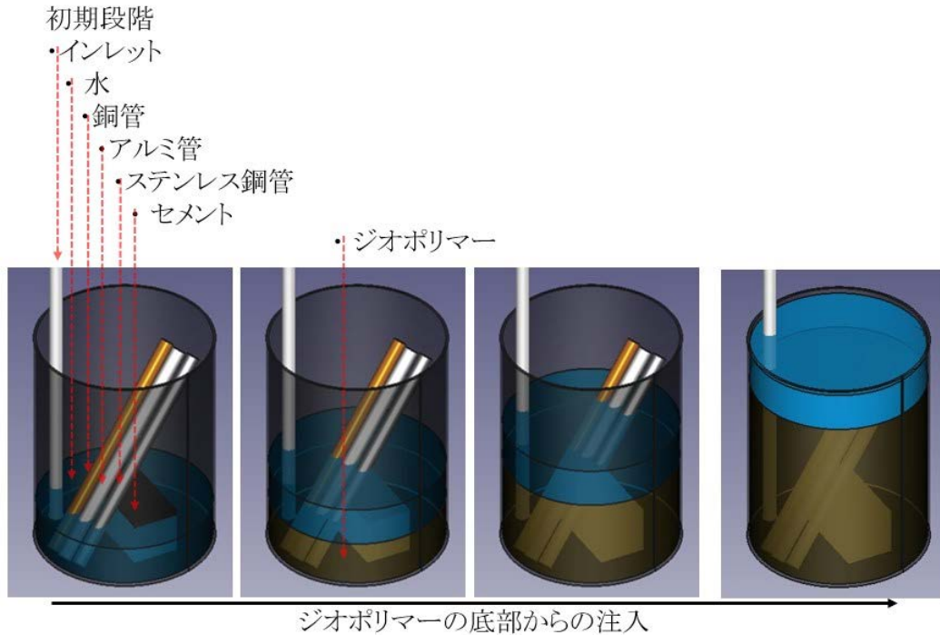
図 3.2.4-2 水中注入試験の進行イメージ (配管等を含む 3 L 試験容器内の水にジオポリマーを注入する場合)
