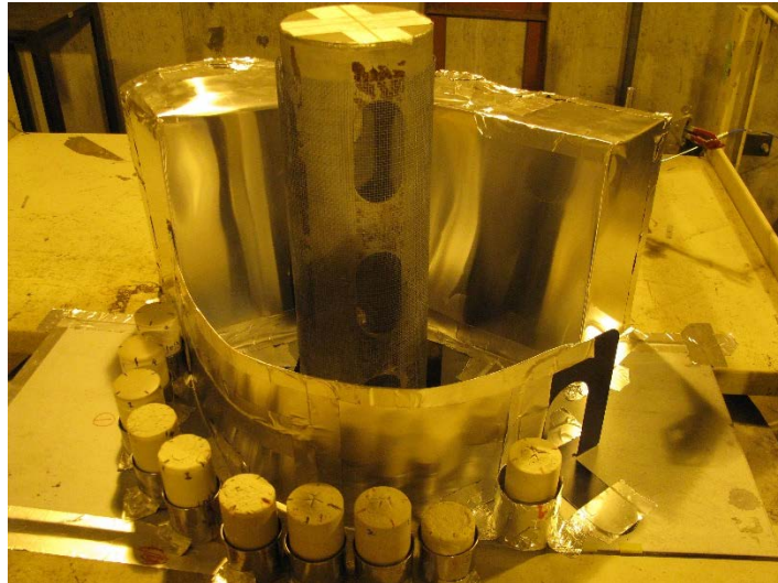
図 3.2.3-5 室温照射試験状況 (引張強度評価)
