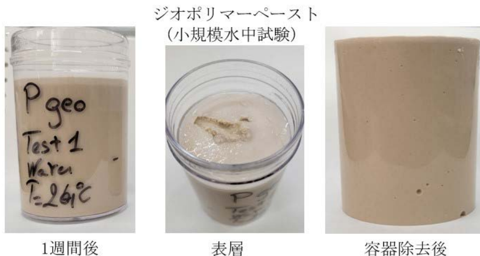
図 3.2.4-6 室温小規模試験後 7 日間養生したジオポリマーペーストの写真
