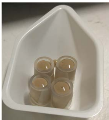
図 3.4-1 PFA 製のチューブ内でのジオポリマー試験体の養生の様子
