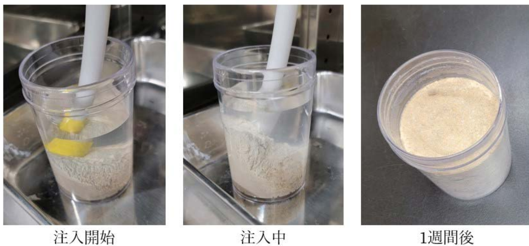
図 3.2.4-8 80 °C小規模試験のジオポリマーモルタル注入時及び 7 日間養生後試料の写真
