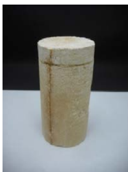
(a) 沈降型重泥水の乾燥供試体
