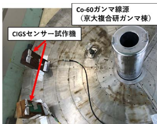
図 3.7.19 太陽電池型線量計の多接続システム照射試験
