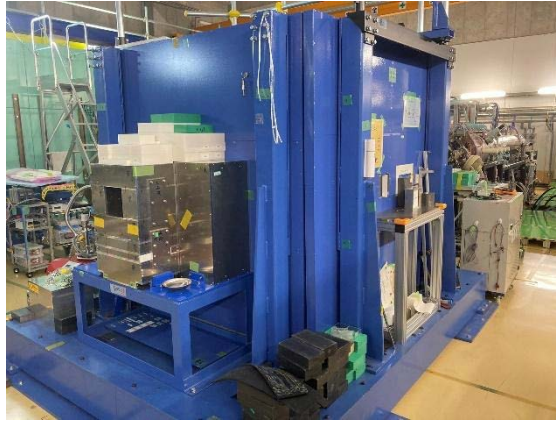
図 3.4.1 加速器駆動小型中性子源 RANS の遮蔽体と中性子ビーム照射口
