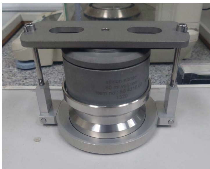
図 3.2.1 ボールミリング用に導入した窒化ケイ素製容器
