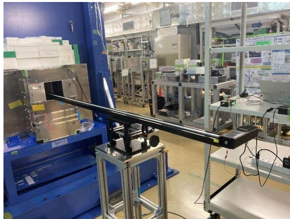
図 3.4.2 中性子ビーム照射口に挿入された直線駆動システム
