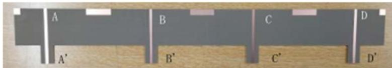
(b) 平衡給電線路（表裏同一パターン）
