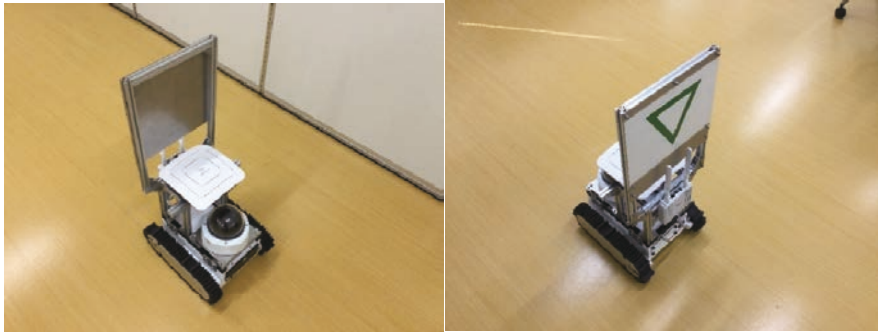
図 3.4-5 中継ロボット（俯瞰写真）
