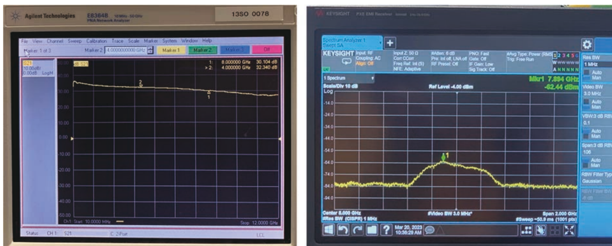
図 3.2-9 左：アンプとケーブルの利得の測定、右：UWB 信号の電力の測定
