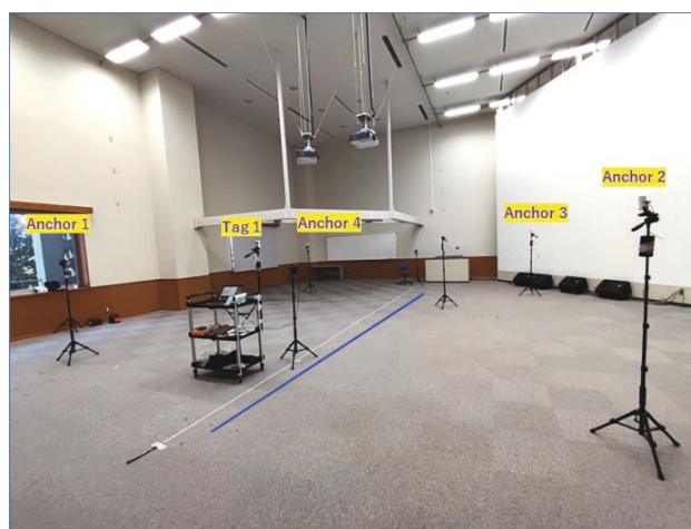
図 3.3-5 UWB 測位精度解析のための屋内テストエリア
