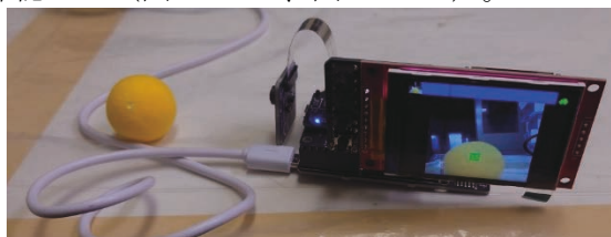
図 3.1-12 耐放射線試験に用いた組込装置 Spresense1 台
