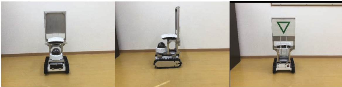
図 3.4-6 中継ロボット（前面、後面および側面写真）
