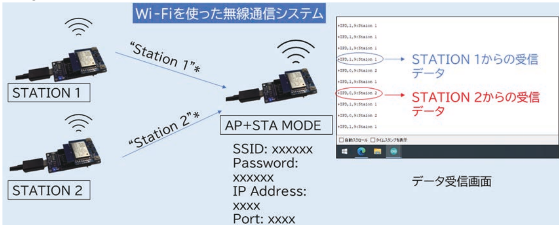
図 3.1-3 Wi-Fi 搭載組込装置 Spresense による相互間通信に関するシステム概念図と結果
