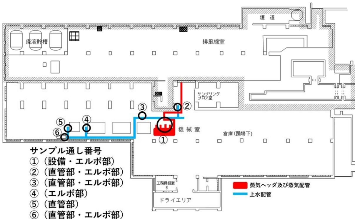
図 2-4 サンプリング箇所 概略図 (第4回アスベスト調査)
