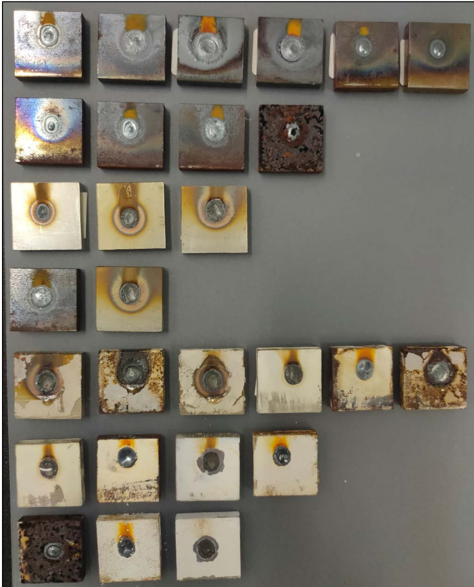
図 3.1-6 レーザー照射後の試験片一式
