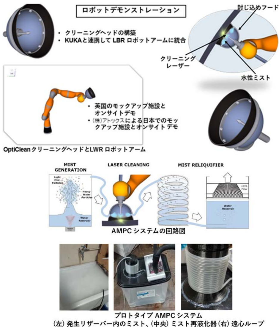
図 3.2-4 レーザー除染装置のセットアップ
